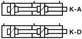
Aus einem einzigen Kolbenpaar bestehender Zylindertyp, dessen Schubkräfte doppelt so hoch sind wie die eines ISO-Zylinders mit demselben Durchmesser (Tabelle Seite 11).
